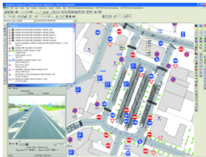
Figura 3 - Visualizzazione della segnaletica stradale orizzontale e verticale, alberatura e del filmato georeferito
